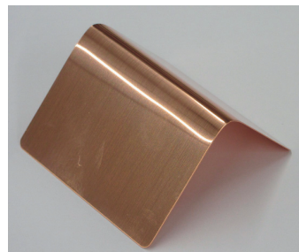
Protector HB-HR1 塗膜の折曲げ試験 Bending test
