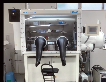
グローブボックス装置内で製膜 Film formation in glove box device
