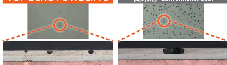
CASS試験80時間後の表面外観と腐食孔の断面外観
